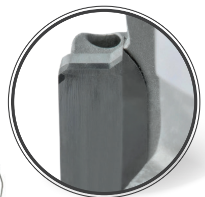
PKD-Schneide mit Spanbrechergeometrie
